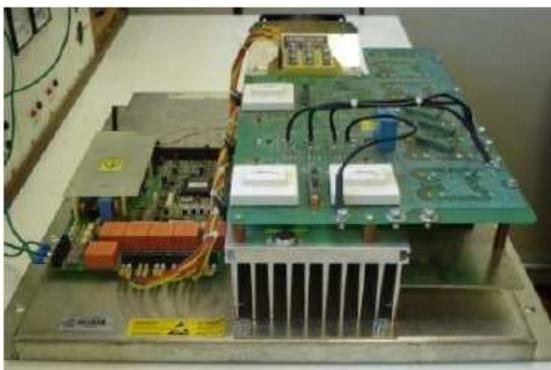
Figura 1. Retificador e inversor usados no projeto.
