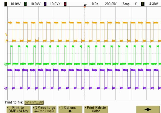
Figura 3. Pulsos gerados pelo software para comando de três chaves do inversor.
